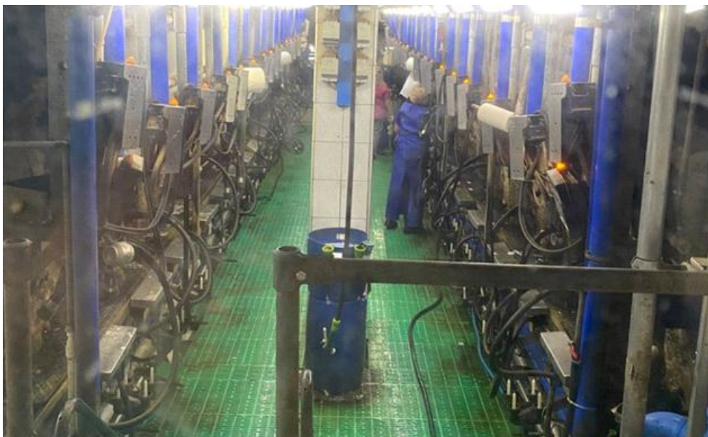
Рисунок 2. Доильная установка «Европараллель» 18 x 18 Де Лаваль Figure 2. Milking installation “Europarallel” 18x18 DeLaval
