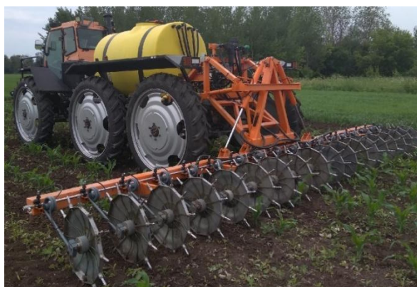
б) Работа мультиинжектора «Туман-2М» на кукурузе с узкими опорными колесами
