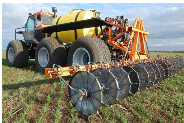
а) Работа мультиинжектора «Туман-2М» на озимой пшенице с широкими опорными колесами агрегата
